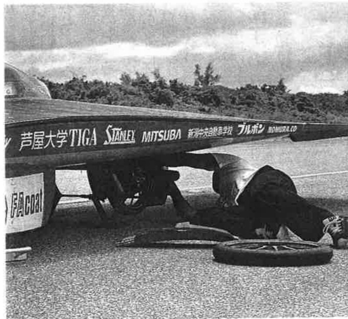
走行中にパンクしたタイヤを高速で修理するスタッフ
