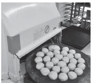
アダナスの製造を支える分割機。決まった分量の生地を入れると、数秒で60gごとに分割。この機械の導入により、製造できるパンの個数と種類が大幅に増えた。
